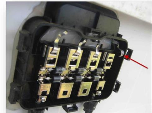
Circuito abierto en una caja de conexiones de un módulo
